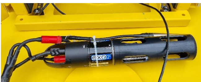
Multiparametersonde EXO2s (mit externer Pegelsonde zur exakten Positionierung der Sonde in der gewünschten Messtiefe)
