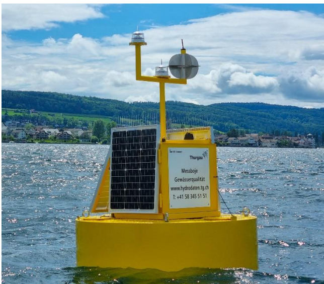
ecoTech Messboje nach Ausbringung und Verankerung
