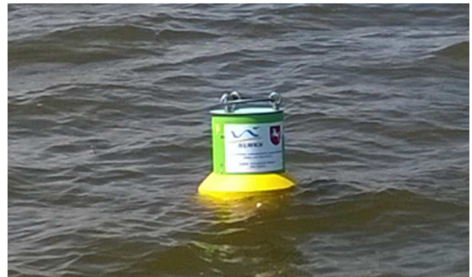
Bild 4: ausgebrachte Messboje im Dümmer See. Der See ist maximal 1,5 m tief und wird von der Hunte durchflossen. Quelle: NLWKN
