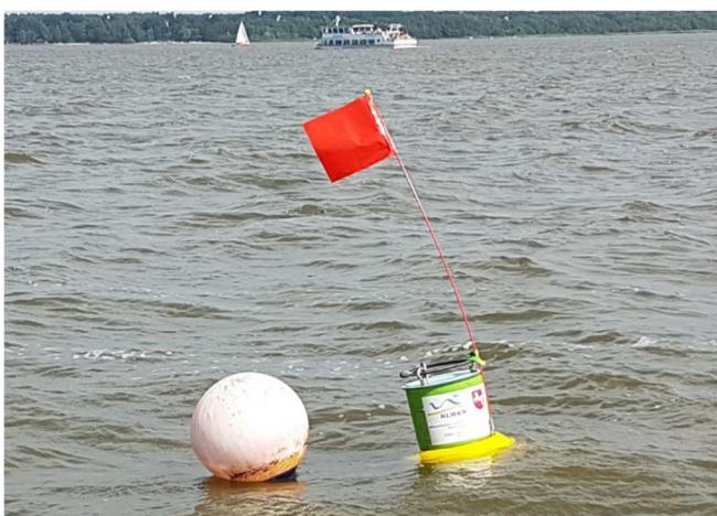
Bild 1: Ausgebrachte Messboje im Steinhuder Meer. Die rote Fahne macht die Messboje auch bei hohem Wellengang sichtbar für Segler. Quelle: NLWKN
