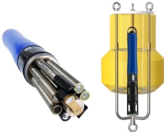
Bild 3: YSI EXO2 Multiparametersonde mit Zentralwischer gegen Biofouling bei langen Einsätzen (links) und schematische Darstellung einer Messboje 50 bestückt mit einer EXO2 Multiparametersonde. Quelle: ecoTech
